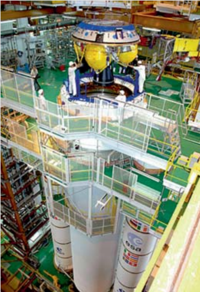
Der ATV-Frachter wird auf die Ariane Rakete montiert
