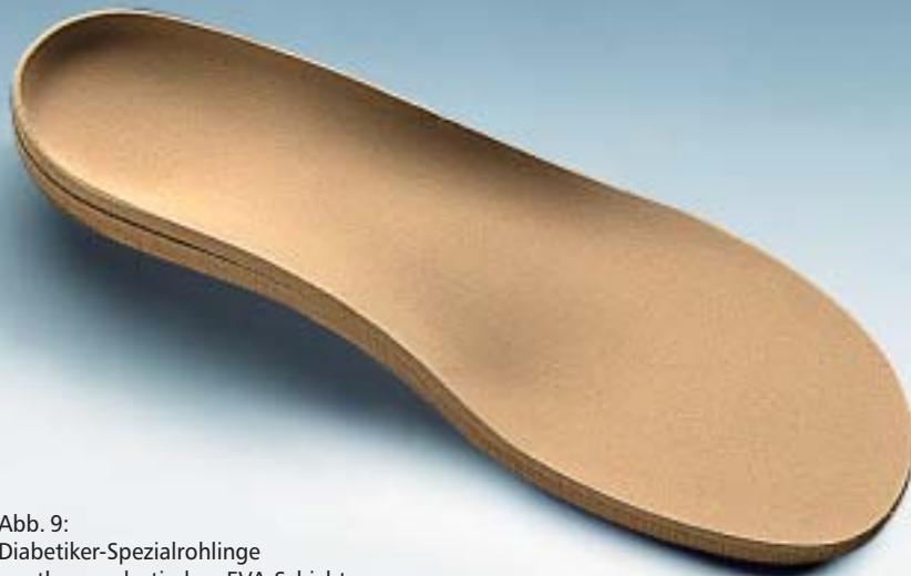
Weichpolster-Rohlinge in Bequemschuh-Form mit Decke aus ARUfoam (10° Shore A), vorne offen, und Medifoam (33° Shore A) mit sehr stabiler tragender Basis (60° Shore A), besonders für übergewichtige Patienten.
