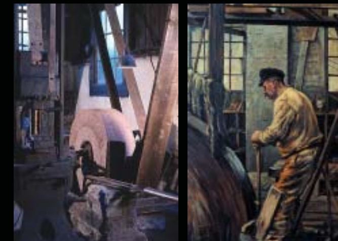
Der Schleifer bei der Arbeit. Stehend, nur angelehnt an ein Brett, stemmte er mit seinem ganzen Körpergewicht das zu bearbeitende Metall gegen den großen Schleifstein.
