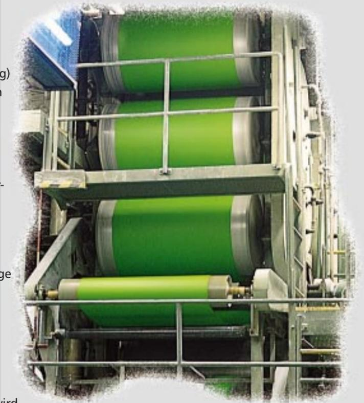
In der Endbearbeitung werden die Platten durch Spalten (Bild unten), Schleifen und Schneiden auf das gewünschte Soll-Maß gebracht.
