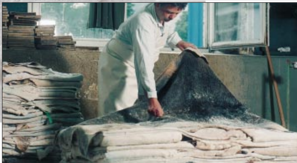
Mit geübtem Blick wird jedes einzelne Fell vor der Gerbung auf sichtbare Fehler kontrolliert.
